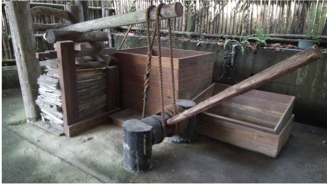
「紙張壓乾機」：紙漿泥糰置於右側斜筒，搗碎成更細紙漿後，再放入中間方形筒狀成形槽內，經沉澱為紙張，再一張一張疊放如左側。經過槓桿及滑輪原理，將紙張壓乾、晾乾為成品。(攝於 2014.5.17.)
